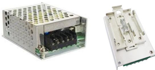
可选择导轨安装方式，型号后面（导轨）
